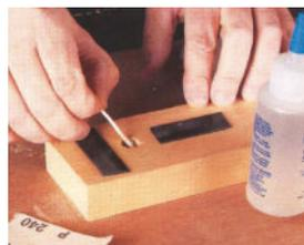
**9** Etalez un peu de colle époxy sur les fraises de la partie supérieure de l'ancrage.
