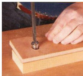
**11** Vissez l'ancrage jusqu'à ce que le fraisage soit de niveau avec la plaque de sol, comme indiqué sur la photo. Essuyez les traces de colle qui dépassent et laissez la colle sécher. Le travail est terminé.
