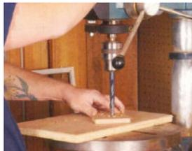
**6** Réalisez une fraisure pour que l'ancrage soit bien maintenu à la surface de la plaque de sol. Il faut maintenir une bonne pression car vous allez aléser. Vous ne pouvez pas percer trop profondément car la bague empêche le foret de descendre plus que nécessaire.
